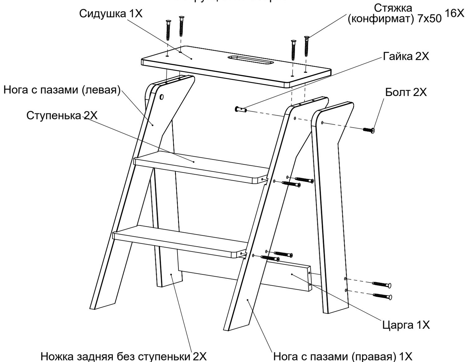
Закрепить в соответствии с рисунком с помощью прилагаемых стяжек. После установки стяжек установить заглушки
