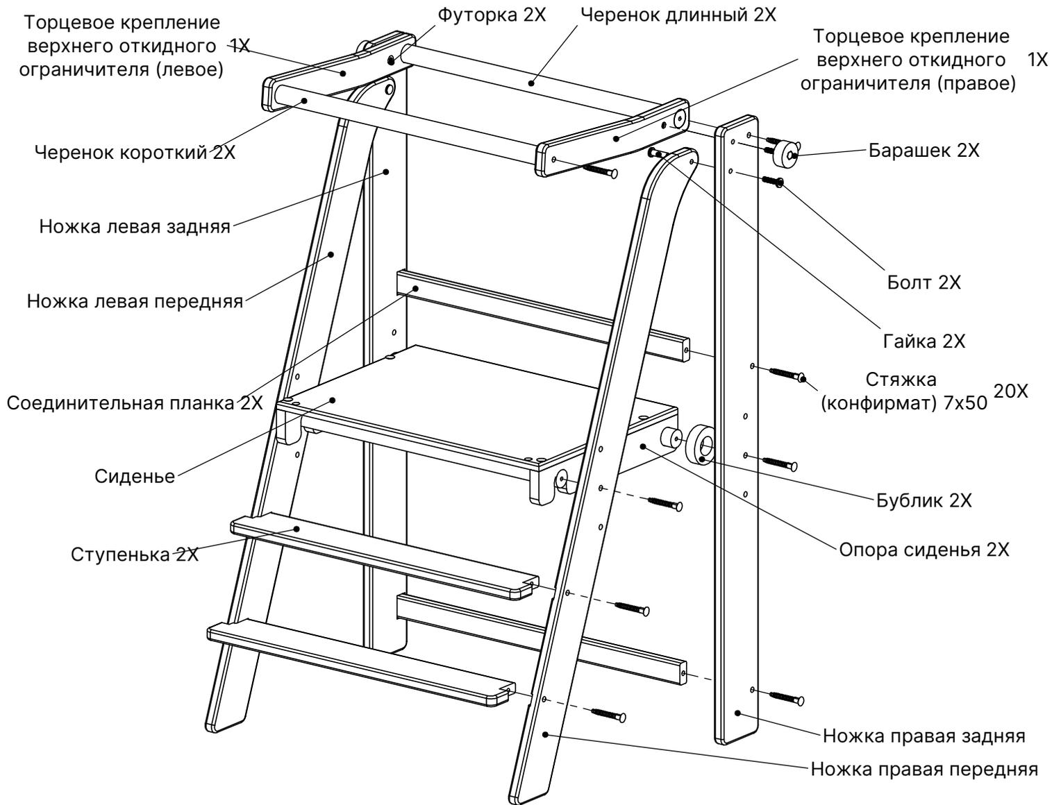
Закрепить в соответствии с рисунком с помощью прилагаемых стяжек. После установки стяжек установить заглушки
